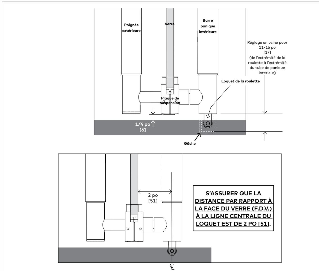
3.1.1 Une fois la porte correctement installée, s'assurer que le loquet de la roulette s'engage correctement avec la gâche.
