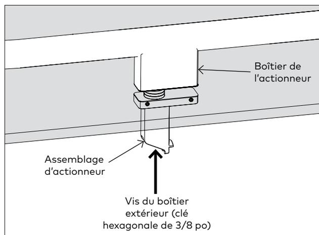
2.2.4 Fixer l'assemblage de l'actionneur (à travers le verre) au boîtier de l'actionneur en serrant la vis du boîtier extérieur.
