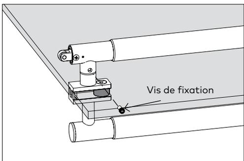
2.7.2 Fixer le tube intérieur à la plaque de montage intérieure sur verre à l'aide de la vis de fixation.
