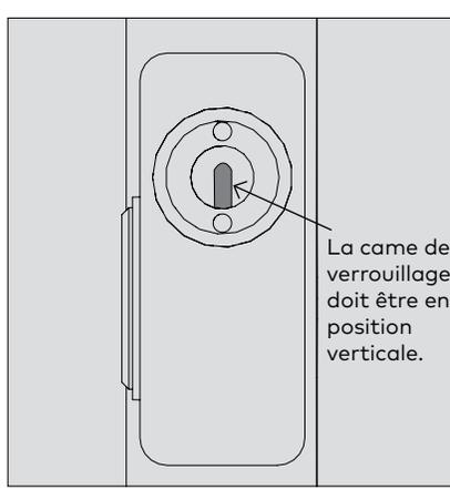
La came de verrouillage doit être en position verticale.
