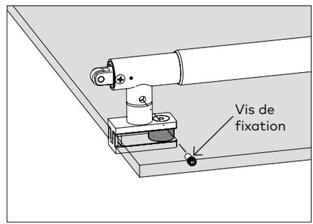
2.7.2 Fixer le tube intérieur à la plaque de montage intérieure sur verre à l'aide de la vis de fixation.
