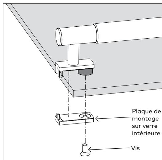
2.3.4 Fixer la plaque de montage intérieure sur verre (à travers le verre) à la poignée extérieure avec la vis de 5/16-18 x 3/4 po incluse.
