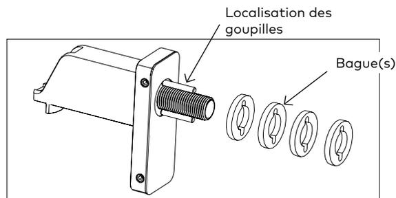
2.2.1 Glisser la ou les bague(s) de l'actionneur sur les goupilles de positionnement de la plaque de montage.
